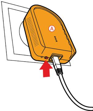
5. Drücken Sie für 2 bis 4 Sekunden den Verbindungsbutton am Hercules ePlug 200 C/Multi Adapter.
