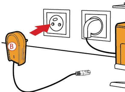
5. Verbinden Sie das andere Ende des Ethernetkabels mit dem Computer, Modem, der Spielkonsole oder jedwedem anderen Netzwerkgerät (z. B. Computer).
