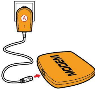
3. Verbinden Sie das andere Ende des Ethernetkabels mit dem Computer, Modem, der Spielkonsole oder jedwedem anderen Netzwerkgerät (z. B. Modem-Router).
