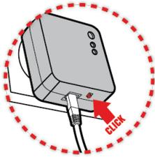
4. Drücken Sie für 2 bis 4 Sekunden den Verbindungsbutton an einem der Adapter, die bereits an das Netzwerk angeschlossen sind.
