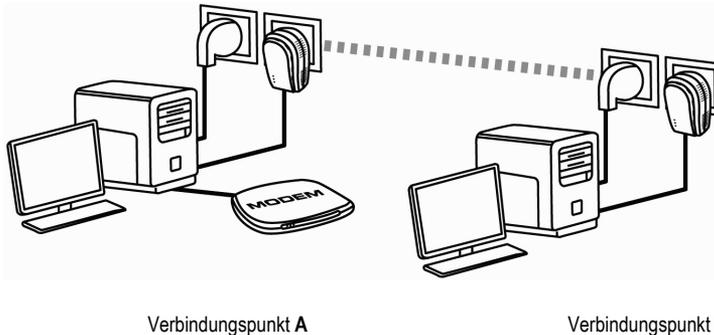
Sie sind im **Ad hoc Modus**. In diesem Modus sind die Computer direkt, **ohne eines Access Points (oder Routers)**, via des HomePlug Netzwerks miteinander verbunden. Damit Verbindungspunkt **B** Zugang zur ADSL Verbindung an Verbindungspunkt **A** bekommen kann:
