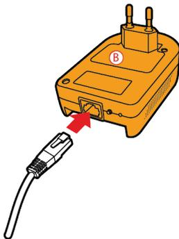
4. Stecken Sie das Ethernetkabel in die Ethernetbuchse Ihres **zweiten Adapters**.
