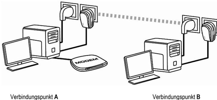
Sie befinden Sie im **Ad-hoc-Modus**. In diesem Modus sind die Computer direkt über das BPL-Netzwerk miteinander verbunden, ohne **Zugriffspunkt (oder Router)**. Damit der Verbindungspunkte **B** auf die ADSL-Verbindung des Verbindungspunktes **A** zugreifen kann, muss:
