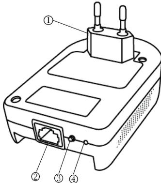
① **Netzstecker**, um den Hercules ePlug 200 C Adapter in eine Steckdose zu stecken
