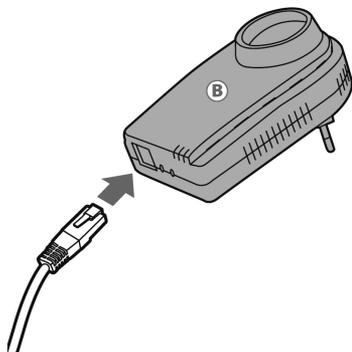
4. Collega il cavo Ethernet al connettore Ethernet del tuo **secondo adattatore**.
