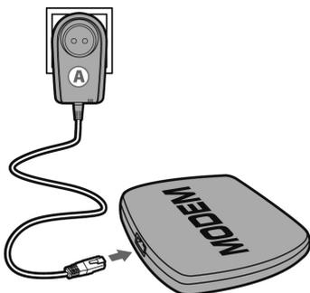
3. Collega l'altra estremità del cavo Ethernet al computer, al modem, alla console o a qualsiasi altra periferica di rete (ad esempio, un modem router).
