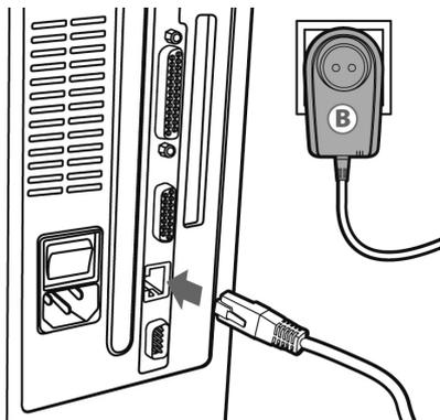
6. Collega l'altra estremità del cavo Ethernet al computer, al modem, alla console o a qualsiasi altra periferica di rete (ad esempio, un modem router).
