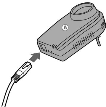
1. Collega il cavo Ethernet al connettore Ethernet del tuo primo adattatore.
