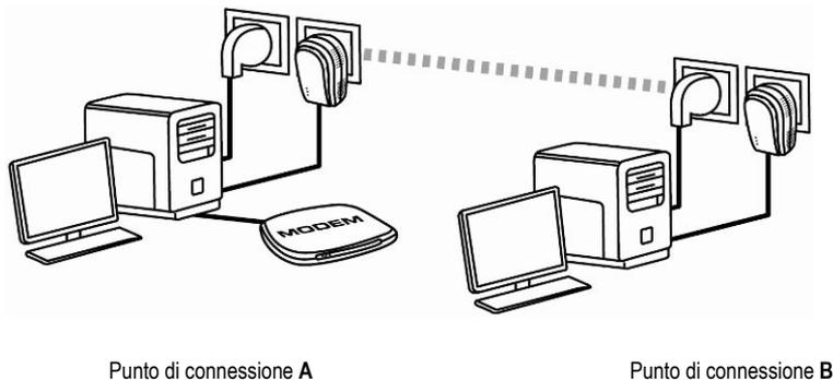
Sei in **modalità Ad hoc**. In questa modalità, i computer sono collegati direttamente l'uno all'altro, **senza un access point (o router)**, tramite la rete HomePlug. Affinché il Punto di connessione **B** possa accedere alla connessione ADSL presente al Punto di connessione **A**:
