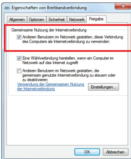
4. Markieren im Register **Freigabe** das Kästchen **Anderen Benutzern im Netzwerk gestatten, diese Verbindung des Computers als Internetverbindung zu verwenden**.
