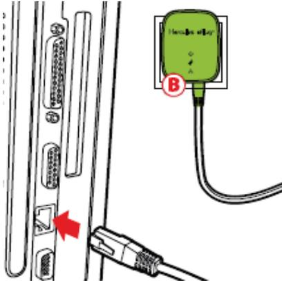
6. Verbinden Sie das andere Ende des Ethernetkabels mit dem Computer, Modem, der Spielkonsole oder jedwedem anderen Netzwerkgerät (z. B. Computer).
