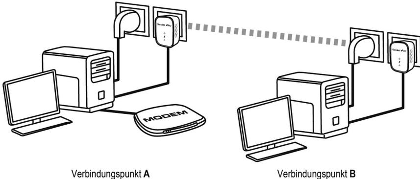
Sie sind im **Ad hoc Modus**. In diesem Modus sind die Computer direkt, **ohne eines Access Points (oder Routers)**, via des HomePlug Netzwerks miteinander verbunden. Damit Verbindungspunkt B Zugang zur ADSL Verbindung an Verbindungspunkt A bekommen kann:
