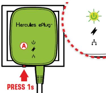
5. Drücken Sie für 1 Sekunde den Verbindungsbutton am Hercules ePlug 500 Nano Adapter.
