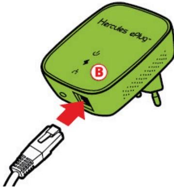
4. Stecken Sie das Ethernetkabel in die Ethernetbuchse Ihres **zweiten Adapters**.
