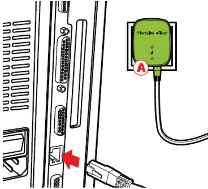
3. Verbinden Sie das andere Ende des Ethernetkabels mit dem Computer, Modem, der Spielkonsole oder jedwedem anderen Netzwerkgerät (hier ein Computer).
