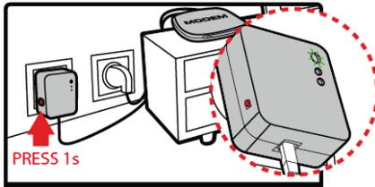
4. Drücken Sie für 1 Sekunde den Verbindungsbutton an einem der Adapter, die bereits an das Netzwerk angeschlossen sind.
