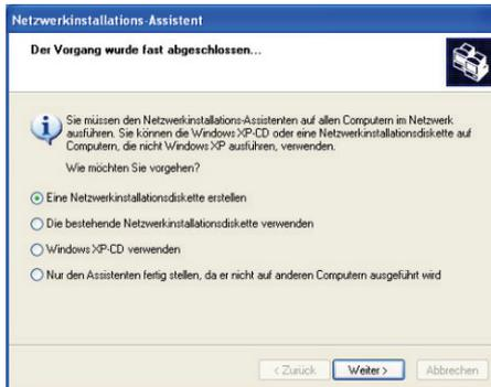
16. Bevor Sie die Prozedur abschließen, können Sie die **Eine Netzwerkinstallationsdiskette erstellen** Option auswählen. Hierbei wird der Wizard auf ein Speichermedium kopiert (Floppy Disk oder US-Stick), so daß dieser auf anderen Computern mit einem anderen Betriebssystem als Windows XP ausgeführt werden kann.
