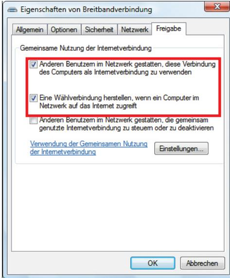
4. Im Freigabe Tab markieren Sie die Kästchen **Anderen Benutzern im Netzwerk gestatten, diese Verbindung des Computers als Internetverbindung zu verwenden** und **Eine Wählverbindung herstellen, wenn ein Computer im Netzwerk auf das Internet zugreift**.
