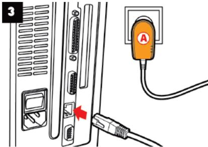
3. Verbinden Sie das andere Ende des Ethernetkabels mit dem Computer, Modem, der Spielkonsole oder jedwedem anderen Netzwerkgerät (hier ein Computer).
