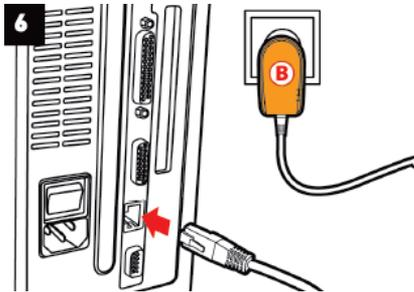
6. Verbinden Sie das andere Ende des Ethernetkabels mit dem Computer, Modem, der Spielkonsole oder jedwedem anderen Netzwerkgerät (z. B. Computer).
