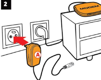
2. Stecken Sie den Adapter in eine Steckdose in der Nähe des Gerätes, das Sie mit dem Netzwerk verbinden wollen.
