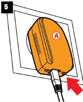
5. Drücken Sie für 2 bis 4 Sekunden den Verbindungsbutton am Hercules ePlug 200 Mini V2 Adapter.
