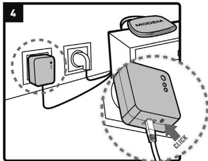
4. Drücken Sie für 2 bis 4 Sekunden den Verbindungsbutton an einem der Adapter, die bereits an das Netzwerk angeschlossen sind.
