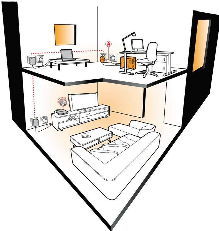
El ordenador ya puede acceder a Internet mediante el módem, puesto que los dos dispositivos están conectados entre sí mediante la red HomePlug y tienen la misma contraseña de red.
