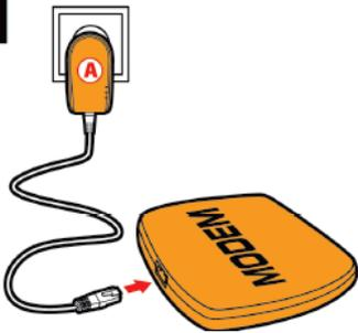
3. Ligue a outra extremidade do cabo Ethernet ao computador, modem, consola de jogos ou qualquer outro dispositivo de rede (por exemplo, um modem/router).
