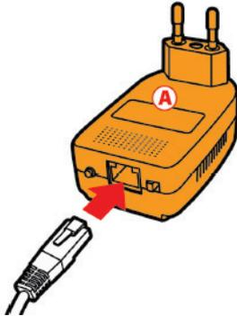
1. Ligue o cabo Ethernet à tomada Ethernet do seu novo adaptador.
