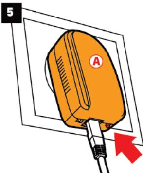
5. Prima durante 2-4 segundos o botão Connect do adaptador Hercules ePlug 200 Mini V2.
