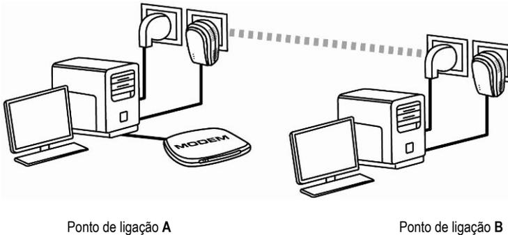
Está em **modo Ad hoc**. Neste modo, os computadores encontram-se directamente ligados entre si, sem **ponto de acesso (ou router)**, através da rede PLC. Para que o Ponto de ligação **B** acesse à ligação ADSL do Ponto de ligação **A**:
