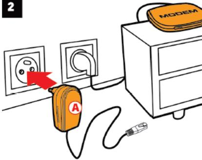
2. Ligue o adaptador a uma tomada eléctrica situada próximo do dispositivo a ligar à rede.
