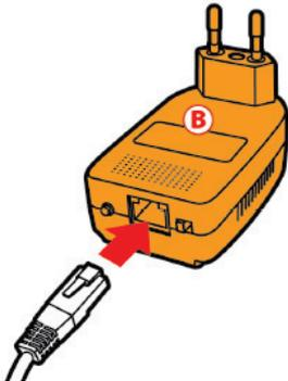
4. Ligue o cabo Ethernet à tomada Ethernet do **segundo adaptador**.
