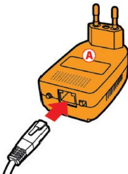
1. Ligue o cabo Ethernet à tomada Ethernet do primeiro adaptador.
