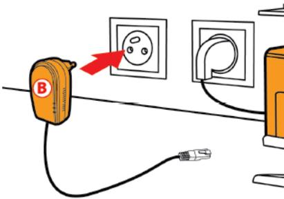
5. Ligue o adaptador a uma tomada eléctrica situada próximo do dispositivo a ligar à rede.
