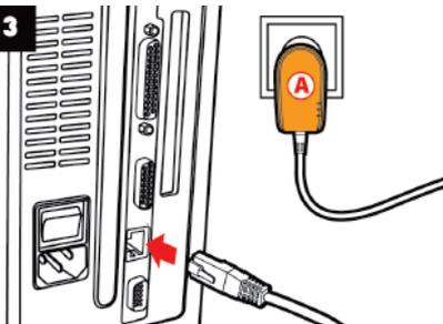
3. Ligue a outra extremidade do cabo Ethernet ao computador, modem, consola de jogos ou qualquer outro dispositivo de rede (neste caso, um computador).
