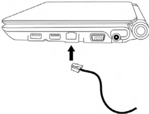
Das eCAFÉ™ verfügt über einen RJ45-Ethernetport, der Ihnen ermöglicht, sich an ein lokales, kabelgebundenes Ethernetnetzwerk 10/100Mbps (z. B.: Firmennetzwerk, kabelgebundener/kabelgebundenes Router/Modem oder Internetbox) anzuschließen.
