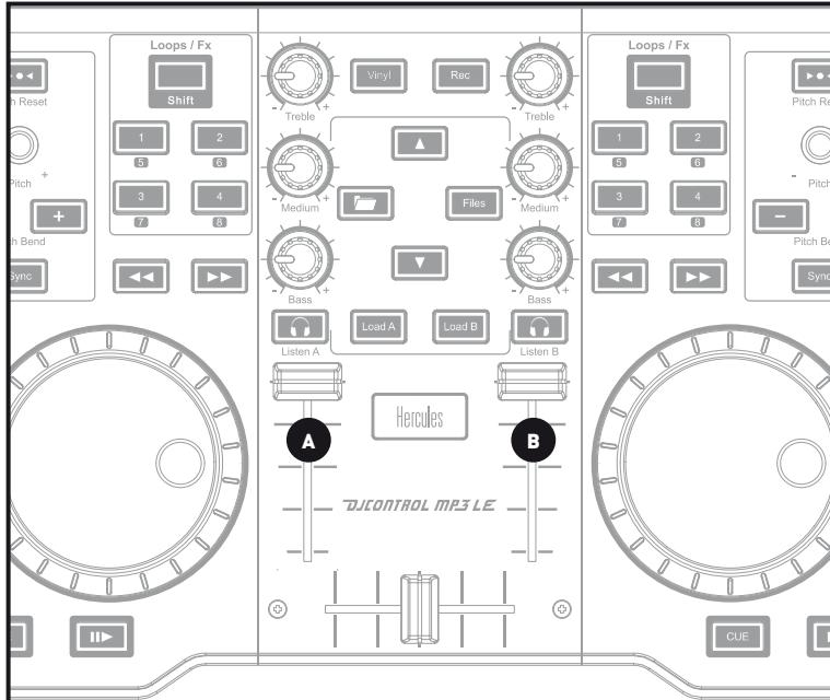
**3.2** Πατήστε το κουμπί στο πλατό B (γίνεται φόρτωση του πλατό στο οποίο θέλετε να πραγματοποιήσετε προεπισκόπηση του κομματιού).
