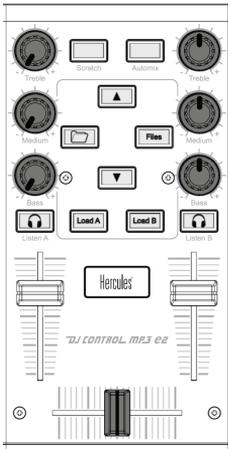
**Paso 4:** Silencia los controles de EQ (ruedas **Treble**, **Medium** y **Bass**) del deck A.
