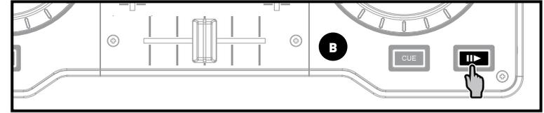
4.6 Pour assurer une transition dans le même temps, synchronisez les BPM (nombre de battements par minute) du morceau qui attend d'être diffusé. Ici, appuyez sur le bouton **Sync** de la platine B (1) pour que le BPM de ce morceau soit identique à celui du morceau qui va se terminer (sur la platine A). Ou réglez les BPM au niveau de ceux de la platine A à l'aide de l'encodeur de pitch (2).
