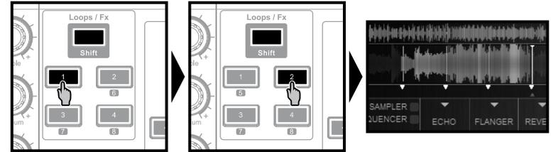
Appuyez sur le bouton 3 pour diminuer la boucle de moitié et sur le bouton 4 pour doubler la longueur de la boucle.
