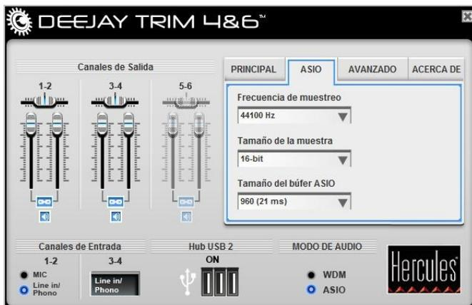
"Audio Stream Input/Output" es un protocolo de transferencia de audio multiplataforma y multicanal desarrollado por la compañía Steinberg. Permite a distintos programas comunicarse con diferentes tarjetas de sonido y reconocer todas las entradas y salidas disponibles en la tarjeta de sonido. El usuario puede asignar esos puertos de entrada y salida para grabar o reproducir al utilizar aplicaciones de software compatibles con ASIO.
