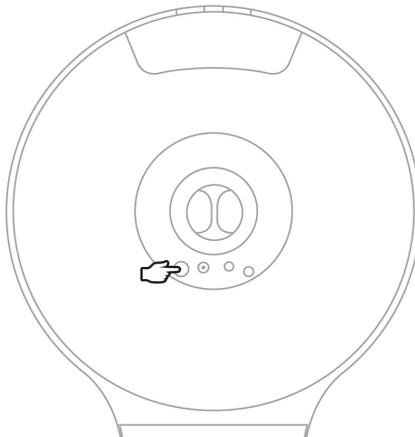
Le témoin de connexion Bluetooth® doit être allumé et clignoter rapidement. L'enceinte est en mode appairage.
