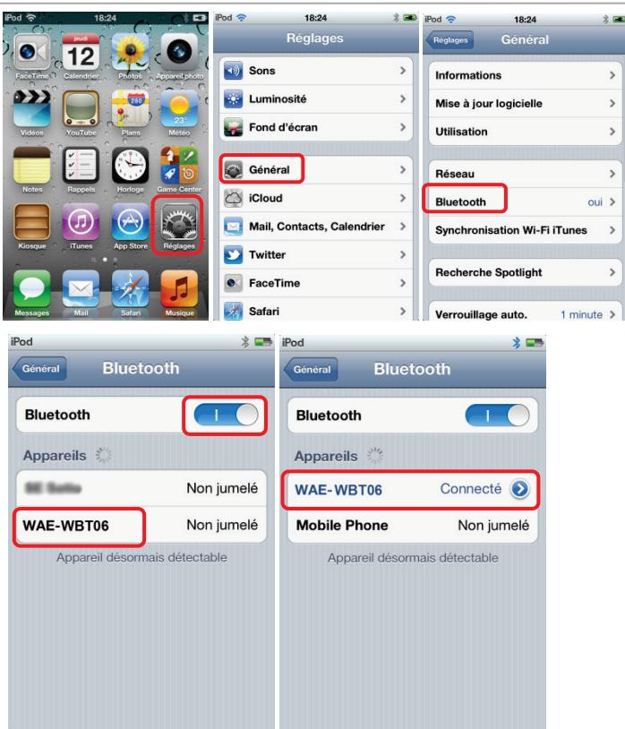
**Remarque :** Si l'enceinte WAE-WBT06 n'apparaît pas, vérifiez le témoin de l'état de connexion (1). Si celui-ci clignote lentement, il est nécessaire de relancer un appairage en appuyant simultanément sur les boutons Volume + (2) et Volume – (3).
