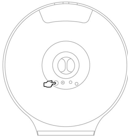
USB dongle bağlantı göstergesi **(18)** ve hoparlörün Açık/Kapalı göstergesi **(4)** sürekli yanmalı, yanıp sönmemelidir.
