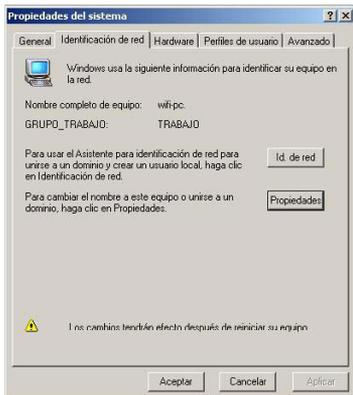
1. Haz clic en **Inicio/Configuración/Panel de control**. Haz doble clic en **Sistema**.
