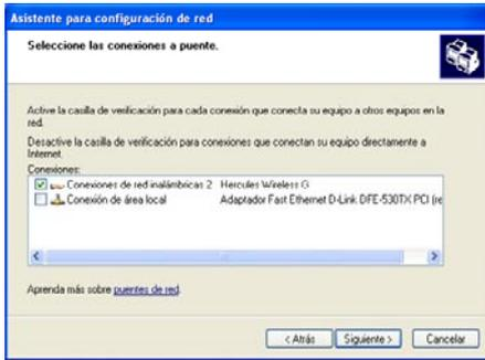
8. Entre las conexiones mostradas, deja marcado el cuadro correspondiente a tu **Conexión de red inalámbrica Hercules Wireless N** y quita la selección de los demás, y luego haz clic en **Siguiete**.
