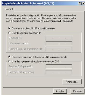
6. En la ventana **Propiedades de Protocolo de Internet (TCP/IP)**, selecciona **Obtener una dirección IP automáticamente** y **Obtener dirección de servidor DNS automáticamente**.
