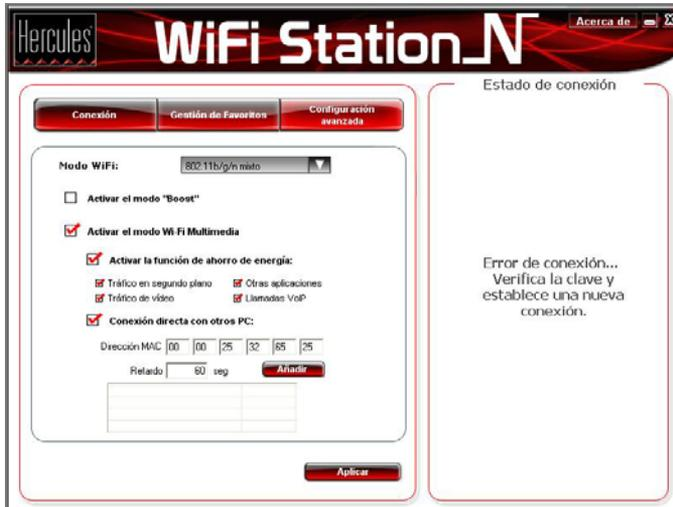
La pestaña **Configuración avanzada** contiene los ajustes avanzados de conexión para el cliente en tu red WiFi. Te recomendamos que **NO** modifiques estos ajustes a menos que sepas exactamente lo que haces.
