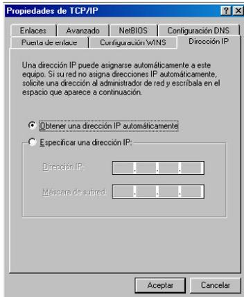
4. En la pestaña **Dirección IP**, selecciona **Obtener una dirección IP automáticamente**.
