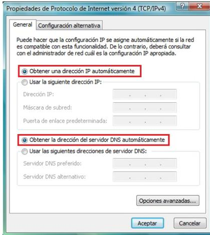
8. En la ventana **Propiedades de Protocolo de Internet versión 4 (TCP/IPv4)**, selecciona **Obtener una dirección IP automáticamente** y **Obtener la dirección del servidor DNS automáticamente**.
