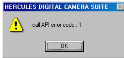
Ces messages apparaissent lorsque le logiciel ne détecte pas le DUALPIX. - Assurez-vous que le DUALPIX est correctement connecté au port USB de l'ordinateur. Vous pouvez essayer en le connectant à l'autre port USB.
