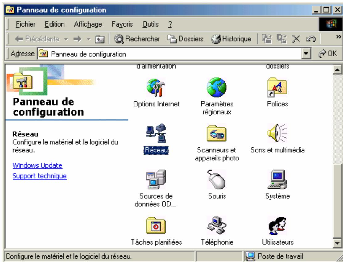
Dans la fenêtre « *Réseau* », sélectionnez l'onglet « *Configuration* » puis sélectionnez le composant réseau « *TCP/IP Hercules Wireless G ...* » et appuyez sur « *Propriétés* ».
