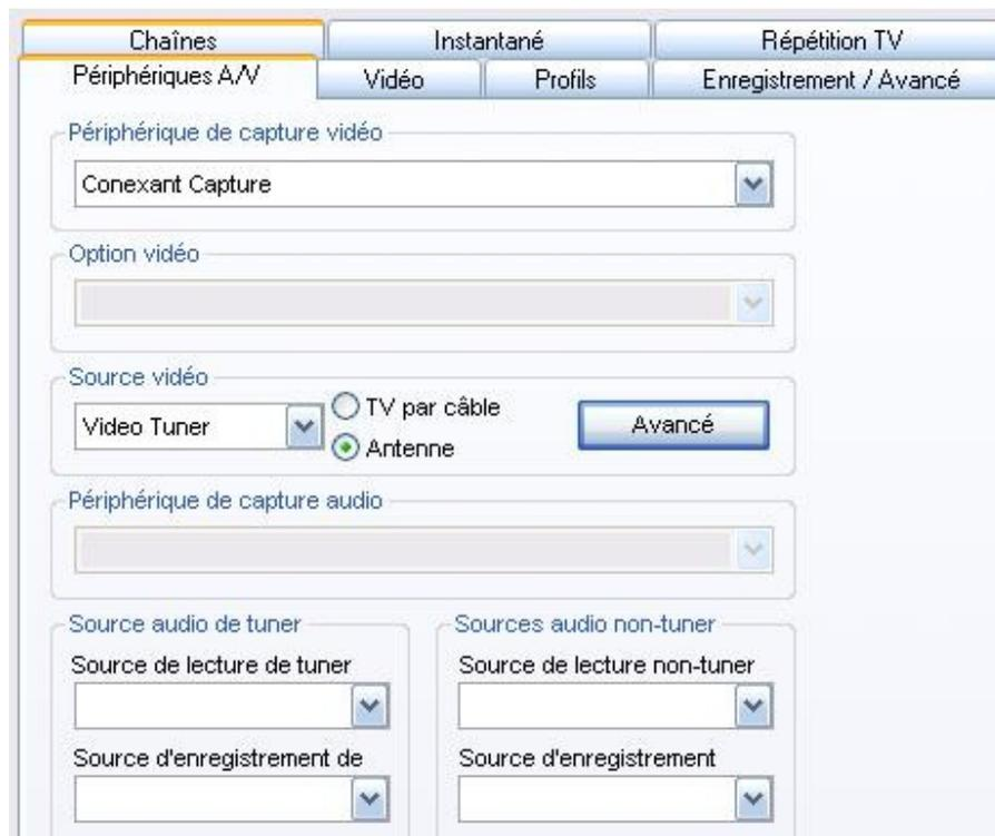
La configuration par défaut est relative à la fonction Tuner. Si vous désirez utiliser la Smart TV pour l'enregistrement de sources vidéo externes ( VCR, caméra), vous devez choisir le connecteur utilisé ( Composite ou S-Vidéo) dans le menu **SOURCE**. Lors de l'utilisation de la carte Smart TV à titre de Tuner, vous devez également le type d'entrée ( Antenne ou câble)..
