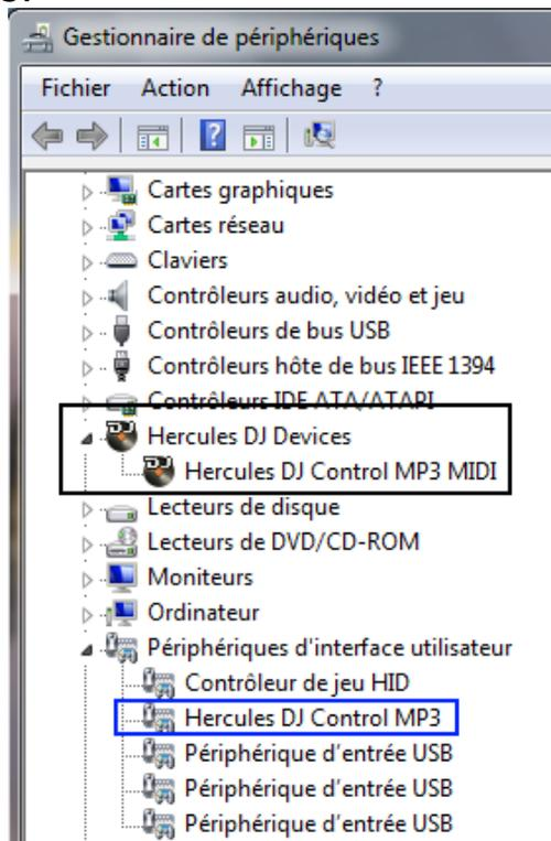
**NOTE:** Si la composante **Hercules DJ Control MP3** (en bleu) apparaît plutôt en tant qu'autre **Périphérique d'interface utilisateur USB**, il ne sera pas possible d'utiliser la console à titre de contrôleur MIDI. Il vous faudra réinstaller le pilote.
