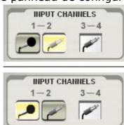
Nous recommandons l'utilisation de microphone dynamique avec la DJ Console. Si vous désirez utiliser un microphone condensateur, notez qu'une alimentation externe sera nécessaire puisque la Console ne fournit aucune alimentation fantôme (+48v).
