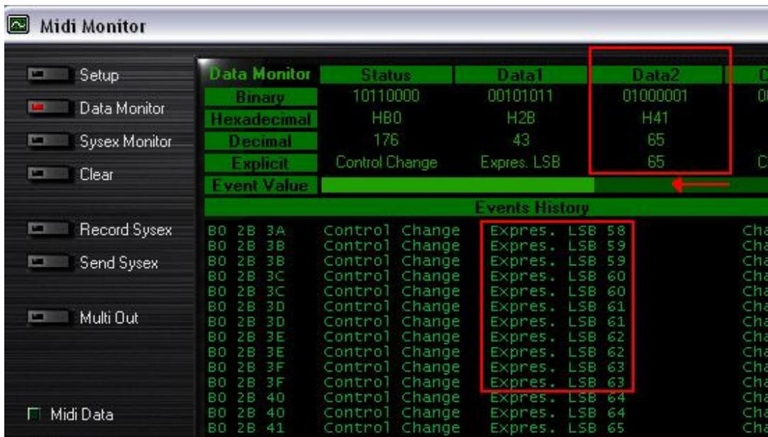
Ce test permet également de déterminer si certains contrôles ne fonctionnent pas correctement. Par exemple, si le crossfader se trouve au centre de sa course mais affiche déjà une valeur maximale de 127
