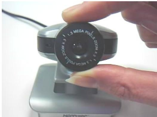
Votre webcam est équipé d'un ajustement logiciel automatique de la netteté de l'image. Toutefois, si le résultat ne vous convient pas, vous pouvez désactiver cet ajustement automatique et effectuer le réglage manuellement de la façon suivante :
