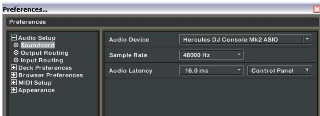
Notez que le **Sample Rate** (Fréquence d'échantionnage) et **Audio Latency** seront différent selon la configuration effectuée dans le panneau de configuration **DJ Console MK2 Control Panel**.
