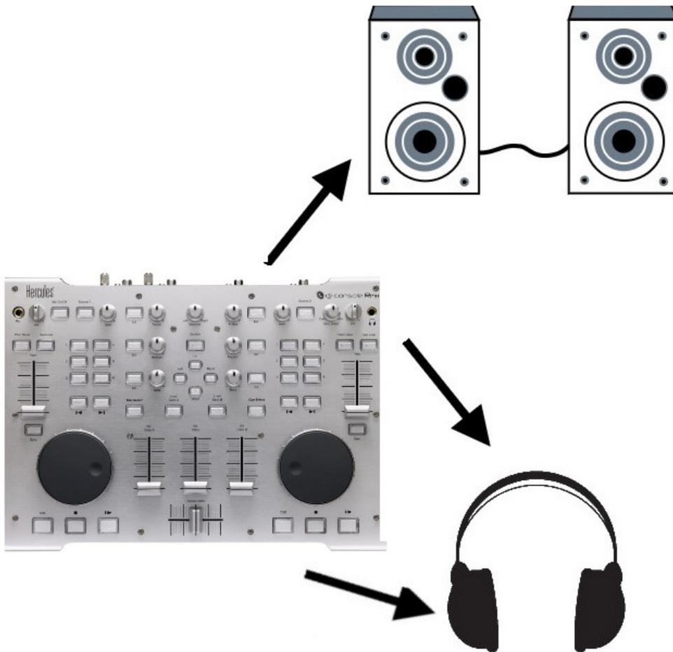
Afin de relier des enceintes pour ordinateur ou une chaîne Hi-Fi à la sortie **Output 1-2** au dos de la Rmx, un adaptateur **RCA mâle à femelle 3.5mm** sera probablement nécessaire.
