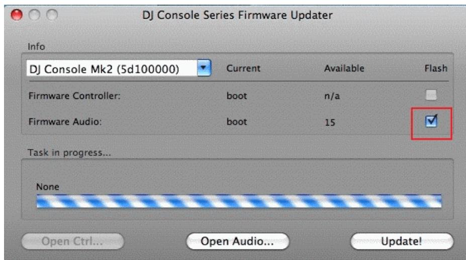
**LA CONSOLE NE DOIT PAS ÊTRE DÉBRANCHÉE** avant d'avoir la confirmation de la mise à jour et le message qui vous dit de déconnecter et reconnecter la console.
