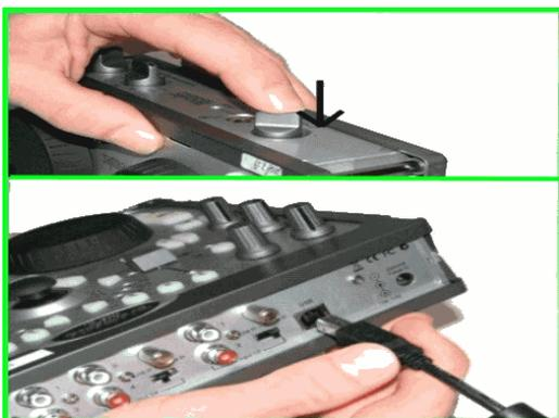
b) Si la colonne **Current** n'affiche pas **boot** OU si la console n'est toujours pas détectée, déconnectez et reconnectez-la en suivant la même procédure, en vous assurant que le bouton **TALK-Over** est **appuyé** avant de reconnecter la console et qu'il est **maintenu enfoncé** une fois la console connectée.
