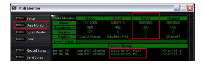
Pour ce qui est des contrôles incrémentaux, tel les EQ et crossfader, vous devriez normalement obtenir des valeurs se situant **entre 0 et 127**, selon la position du contrôleur. La section **Event Value** vous indiquera également la position relative du contrôleur utilisé correspondant à la valeur affichée.
