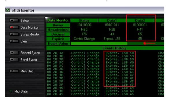
Ce test permet également de déterminer si certains contrôles ne fonctionnent pas correctement. Par exemple, si le crossfader se trouve au centre de sa course mais affiche déjà une valeur maximale de 127
