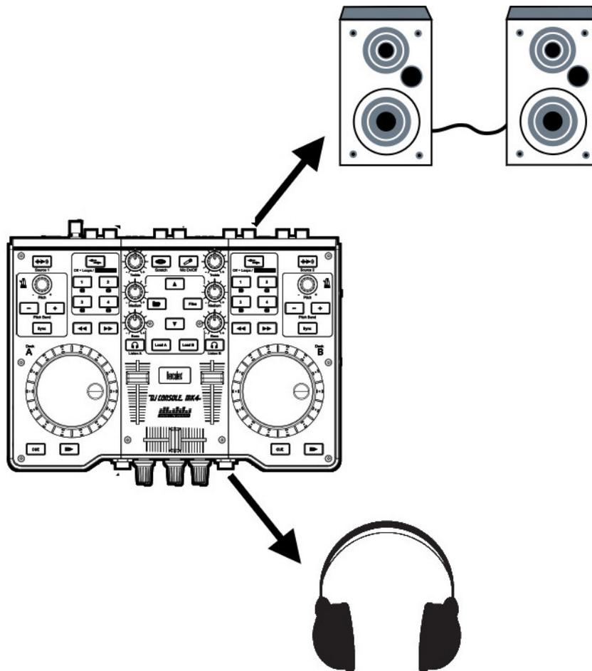
Vous pouvez relier des enceintes pour ordinateur ou une chaîne Hi-Fi à la sortie **Output 1-2** au dos de la Mk4 grâce aux connecteurs Mini jack (3.5mm) ou RCA.
