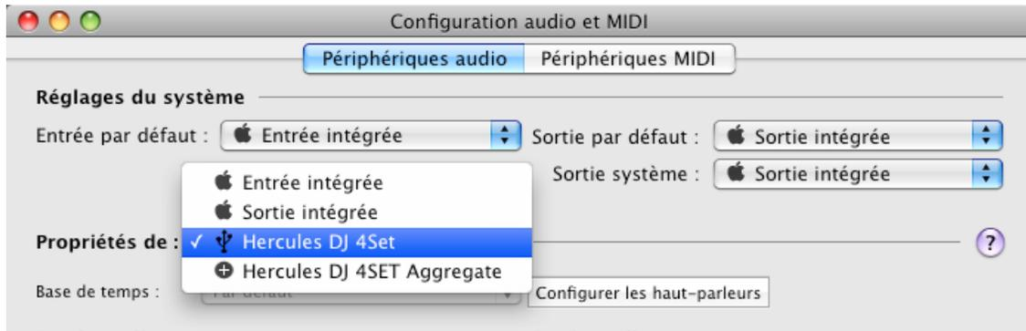
La console devrait apparaître en tant que **Hercules DJ 4Set** ainsi que **Hercules DJ 4Set Aggregate**. Ceci est normal et nécessaire afin de permettre certaines applications DJ d'utiliser les différentes sorties de la 4Set.
