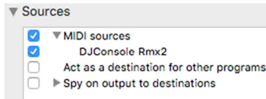
Appuyez d'abord sur l'un des boutons de la DJ Console. Sous la colonne **Data**, dans la partie inférieure de la fenêtre de **MIDI Monitor**, vous devriez obtenir des valeurs de **127** (en appuyant) et **0** (en relâchant).
